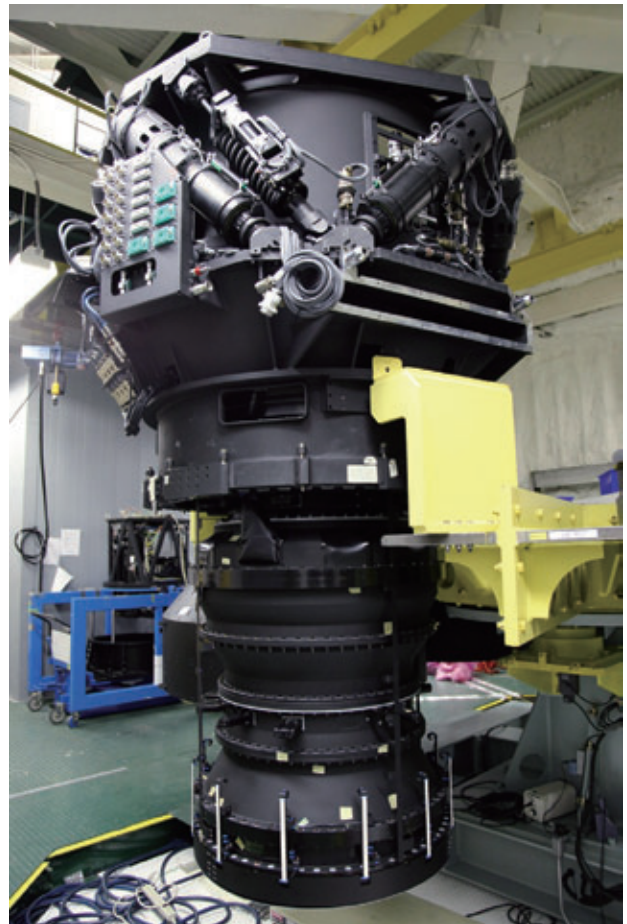
口径8.2mのすばる望遠鏡とHSC。左図はすばる望遠鏡のトップリングに装着したHSC（フィルター交換機構は外してある）の位置を示す。この位置は主焦点と呼ばれ、HSCは主鏡から15mの高さにある（クレジット：国立天文台）。右図は高さ3mのHSC（クレジット：国立天文台）。
