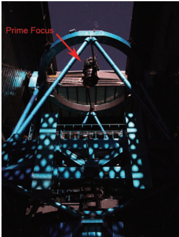
口径8.2mのすばる望遠鏡とHSC。左図はすばる望遠鏡のトップリングに装着したHSC（フィルター交換機構は外してある）の位置を示す。この位置は主焦点と呼ばれ、HSCは主鏡から15mの高さにある（クレジット：国立天文台）。右図は高さ3mのHSC（クレジット：国立天文台）。
