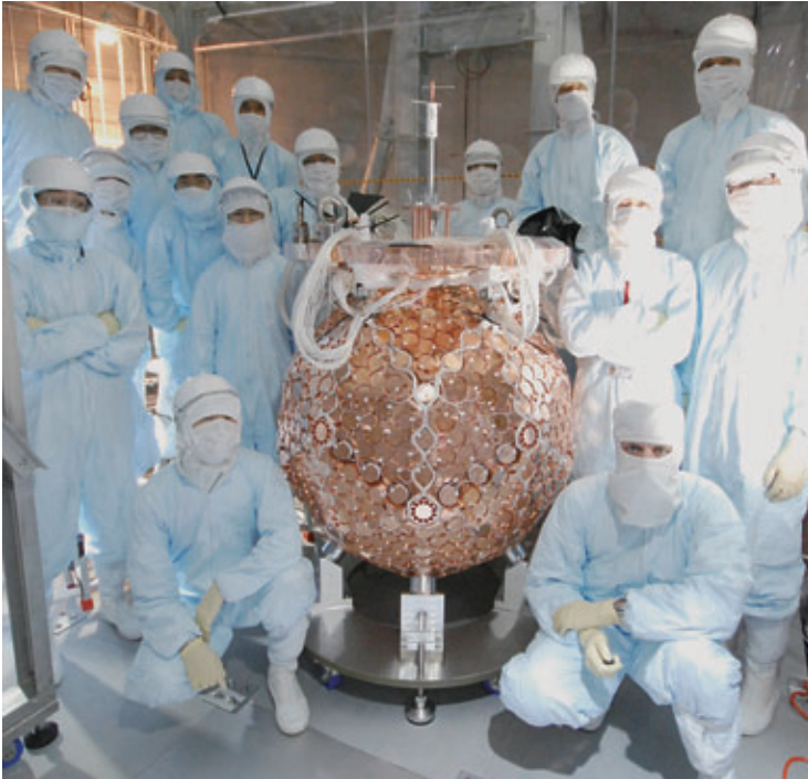
60面体のXMASS測定器と実験チーム。
