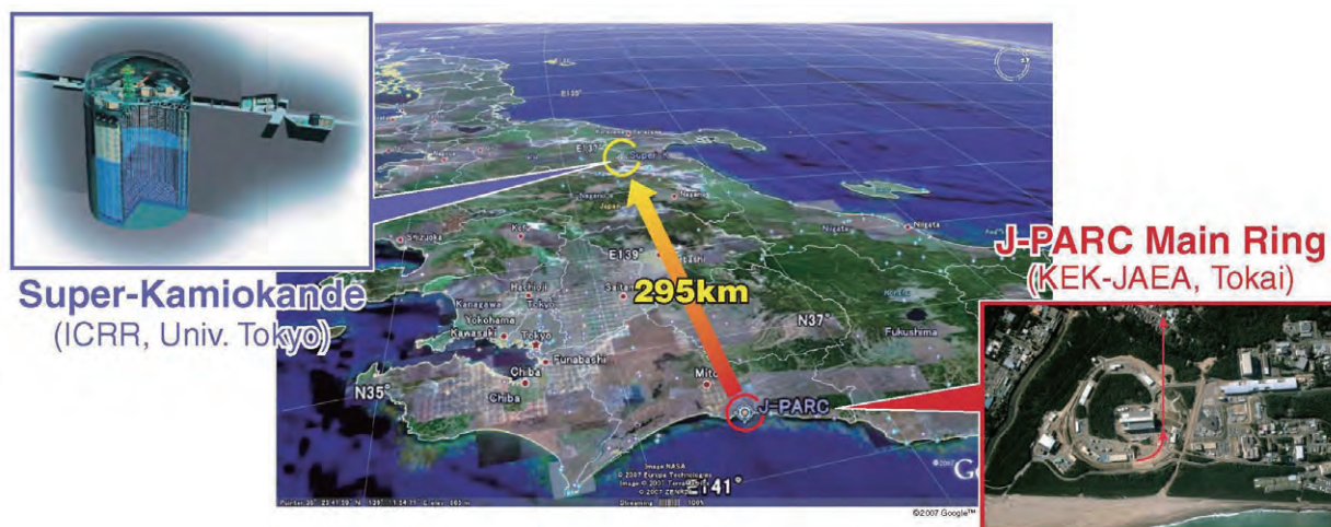
図3 T2K実験は日本の東海岸にある東海村のJ-PARC 施設で発生させたニュートリノビームを使用します。295 km離れたスーパーカミオカンデ検出器により、そのニュートリノのほんの一部が検出されます。
