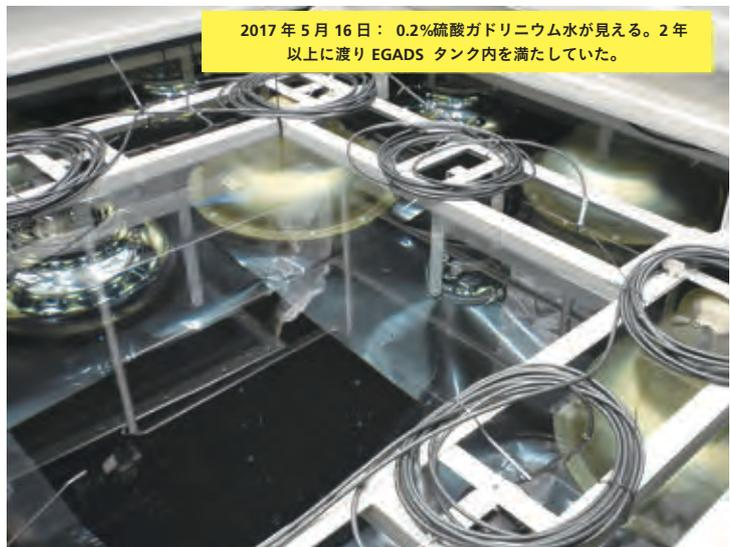
図4 2年間満水状態でガドリニウムを添加した水にさらされたEGADSタンク内を見下ろす。
