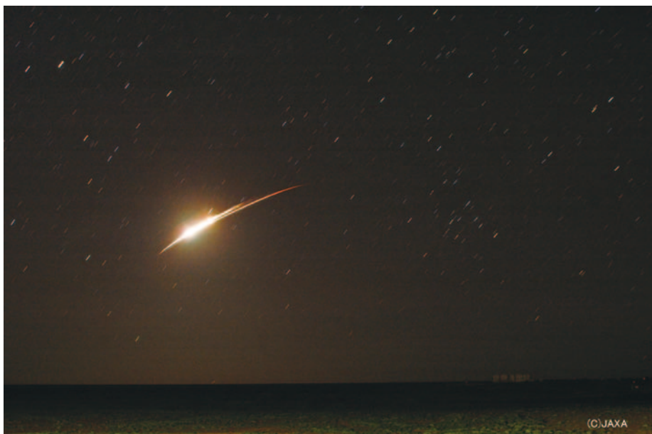
はやぶさは2010年6月13日に地球の大気圏に再突入し、その直前に切り離された試料カプセルはオーストラリアのウーメラ砂漠で回収されました。写真(提供:JAXA、ウーメラで撮影)は左下から大気圏に突入し、燃え尽きるはやぶさ本体の火球。右上方に切り離されたカプセルの光跡が伸びています。
