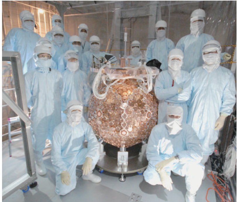
2010年2月に組み立てを終了したXMASS検出装置の中心部分。
